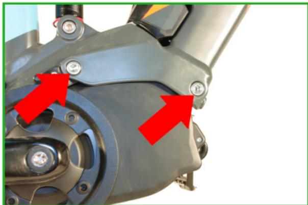
2. Lösen Sie auf der linken Seite die gezeigte Schraube (1) mit einem Inbus Größe 6. Die Schraube bleibt an Ihrem Platz und dient als Scharnier, damit der Motor heruntergeklappt werden kann (2).
